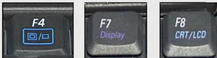
3. Mientras mantiene presionada la tecla **Fn**, presione la tecla "**F**" adecuada y suelte ambas teclas. Este proceso se denomina **activación/desactivación** de la pantalla. Esto podría hacer que la imagen titilara momentáneamente. Hacer esto le indicará a la laptop que exhiba los datos en un dispositivo que no sea sólo la pantalla de la laptop.
