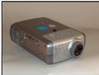
9. Verifique que se haya seleccionado la entrada adecuada en el proyector. El proyector puede tener un botón de detección automática (auto detect) o de imagen automática (auto image), o quizás deba probar varias entradas. Busque un indicador en la pantalla tal como "PC1" o "VGA."
